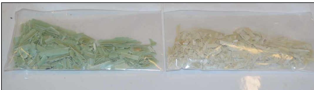
Photo 7 Dépôt prélevé sur la résistance
